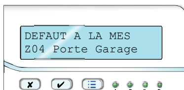
Figure 4. L'afficheur indique une zone en défaut.
